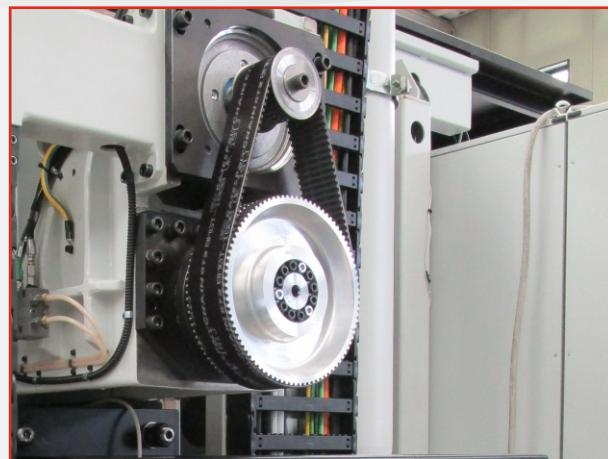
I movimenti longitudinale, trasversale e verticale sono ottenuti tramite motore, cinghia e vite a ricircolo di sfere con doppia chiocciola precaricata con eliminazione totale dei giochi.
