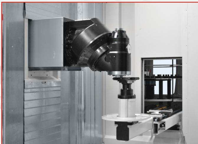
**Magazzino a catena con braccio di scambio posizionato lateralmente al montante della macchina.**
