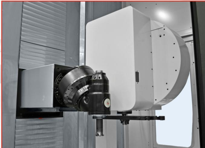
**Magazzino a ruota con braccio di scambio posizionato lateralmente fuori del campo di lavoro.**
