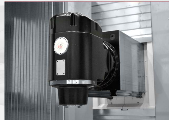
Testa verticale a posizionamento continuo **torque**. Completamente raffreddata con campo di velocità del motomandrino fino a 18000 g/1'
