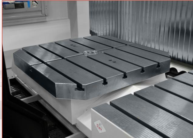
**Tavola girevole in continua per fresatura comandata dal CN ed azionata da motore torque.**
