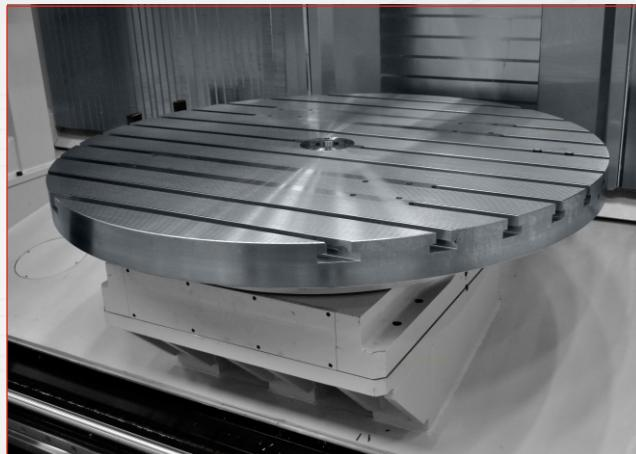
**Tavola girevole in continua per tornitura e fresatura comandata dal CN ed azionata da motore torque.**
