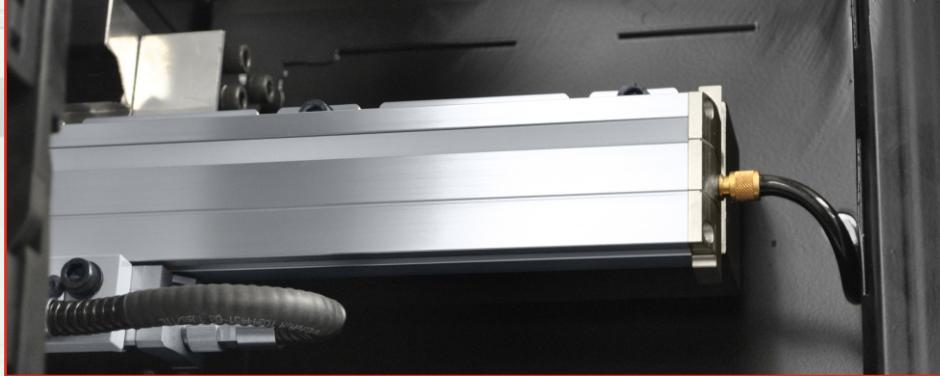
**Trasduttore ottico di posizionamento pressurizzato sui 3 assi**
