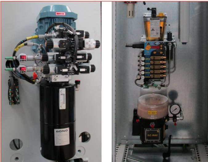
Centralina idraulica e centraline di lubrificazione mandrino e guide.
