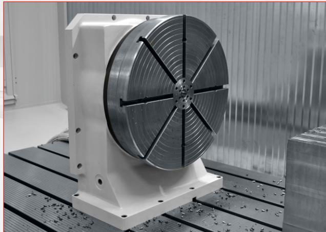
**Divisore comandato dal CN ed azionato tramite motore torque.**
