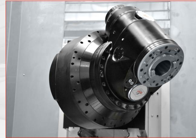
Testa a 2 assi azionata da motori **torque** con posizionamento continuo e contemporaneo ( $0,001^\circ$ ) per ridurre al minimo i tempi del ciclo di lavoro.
