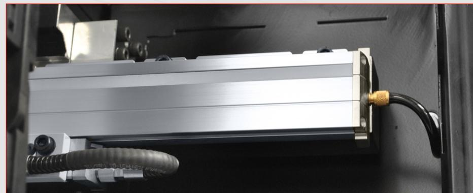
**Trasduttore ottico di posizionamento pressurizzato sui 3 assi • Linear optical pressurized scales on 3 axes**
