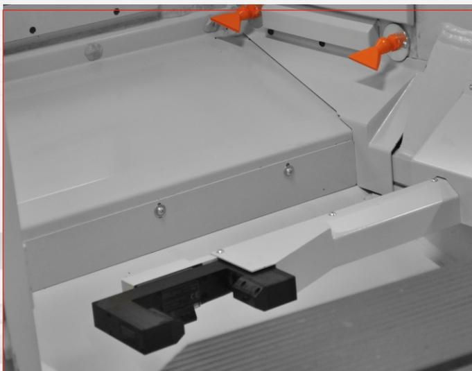
**Sistema di misurazione utensile.**
