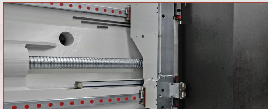
**Guide di scorrimento a rulli ad alta rigidità e precisione lubrificate sui 3 assi**
