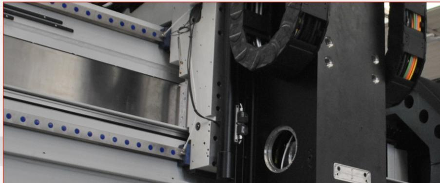
**Guide di scorrimento a rulli ad alta rigidità e precisione lubrificate sui 3 assi**
