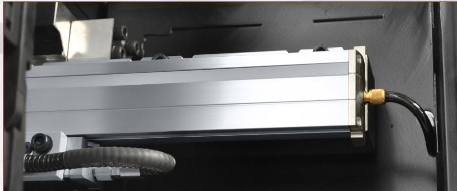
**Trasduttore ottico di posizionamento pressurizzato sui 3 assi**
