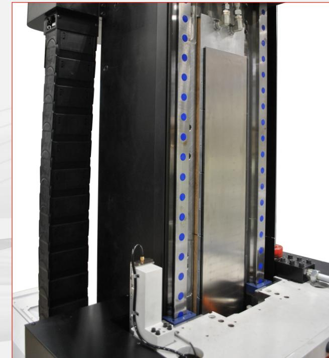
**Movimenti ottenuti tramite un gruppo motore - cinghia - vite a ricircolo di sfere (standard), oppure tramite motori lineari**
