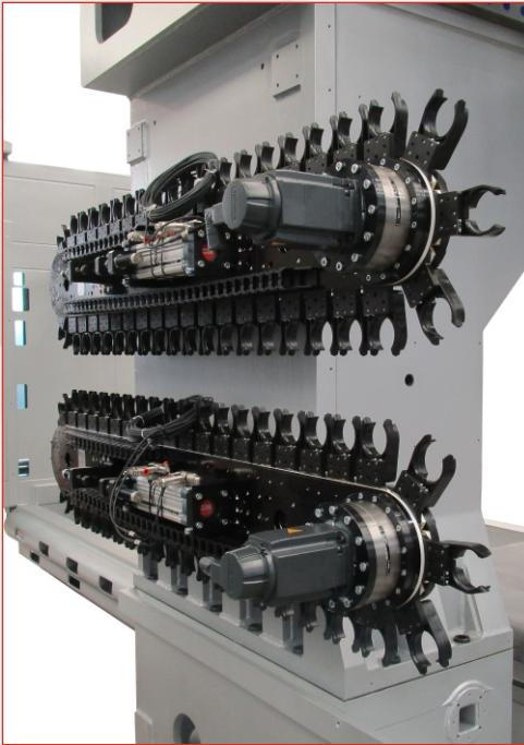
**Magazzino utensili a catena con traslazione posizionato lateralmente al portale della macchina.**
