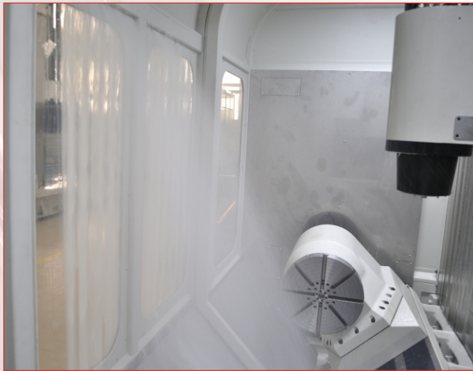
Sistema di lavaggio finestre. Windows washing system. System von Fenster Wäsche. Système de lavage fenêtres.
