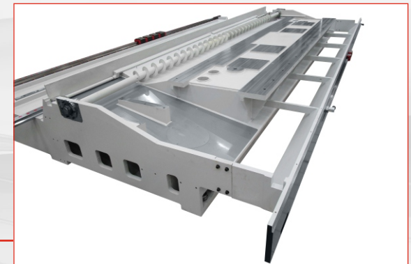
Asse longitudinale • 8 pattini su 2 guide Longitudinal axis • 8 roller pads on 2 guideways Längs Achse • 8 Röllschuhe auf 2 Föhrungen Axe longitudinale • 8 patins sur 2 glissières
